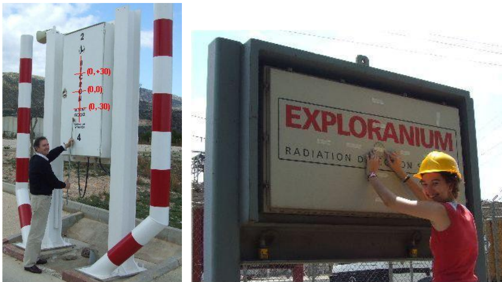
Fig. 1 – Medida de la eficiencia en el centro de la superficie del panel o del detector.
