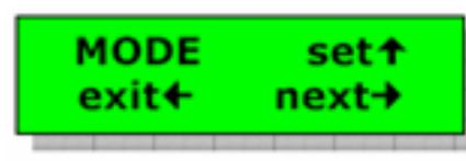
A continuación, se debe seleccionar **set** y aparecerá la siguiente pantalla. Para cambiar de modo, se debe seleccionar **set** hasta que se muestre el modo requerido. Una vez mostrado, salir de los menús seleccionando **exit**.
