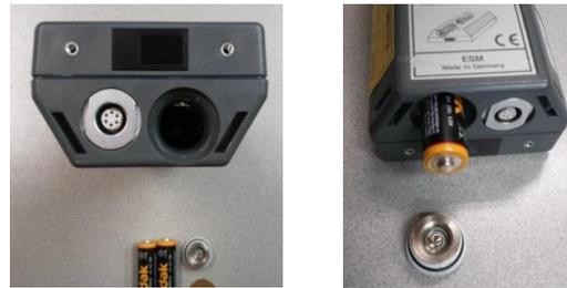
Se mantendrá pulsado el botón de encendido,
